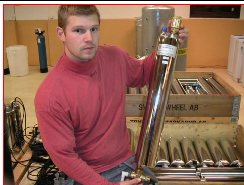
Bilden visar komplett luftblandare Tillverkad i syrafast rostfritt stål SS 4404
